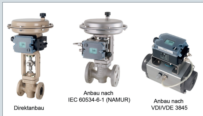
Bild 3: Anbauvarianten des Stellungsreglers Typ 3725 mit geschütztem, berührungslosem Wegsensor
