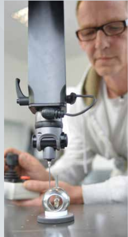
Alle Bauteile werden Stück für Stück 3-D-vermessen und zusätzlich auf ihre Materialqualität hin überprüft.
