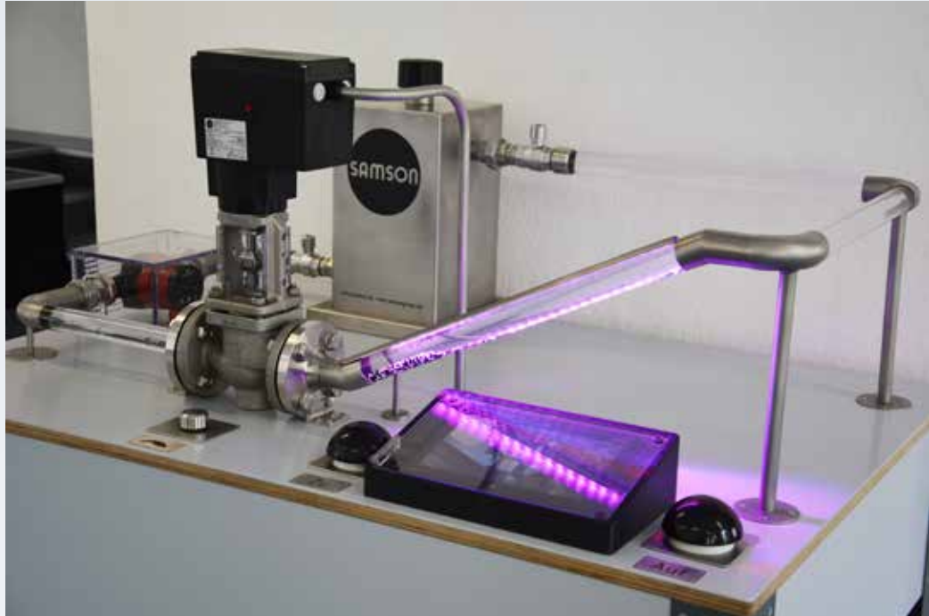
Die Stellung des Ventils im Exponat „Regelung eines Wasserkreislaufes“ kann von den Besuchern der EXPERIMINTA durch Potentiometer direkt beeinflusst werden.
