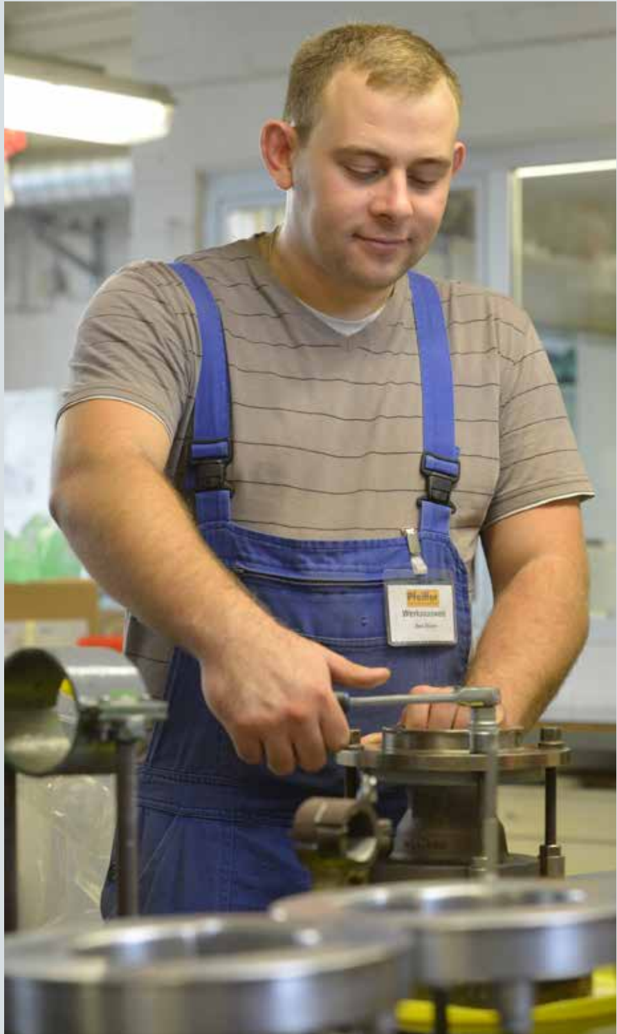
Der mit PTFE auszukleidende Kugelhahn wird für das isostatische Pressen vorbereitet, bei dem das Pulver in einen kompakten Kunststoff verwandelt wird.
