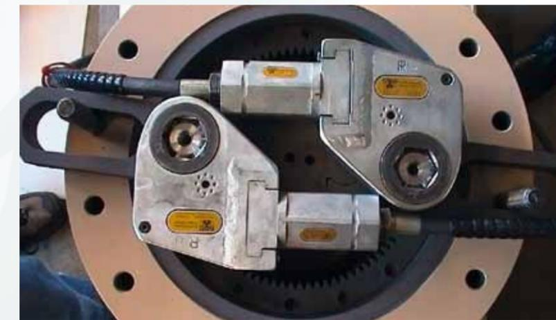
Neben dem Fachwissen der Mitarbeiter kommt auch Spezialwerkzeug zum Einsatz, hier zur Demontage und Montage von Ventilsitzen.
