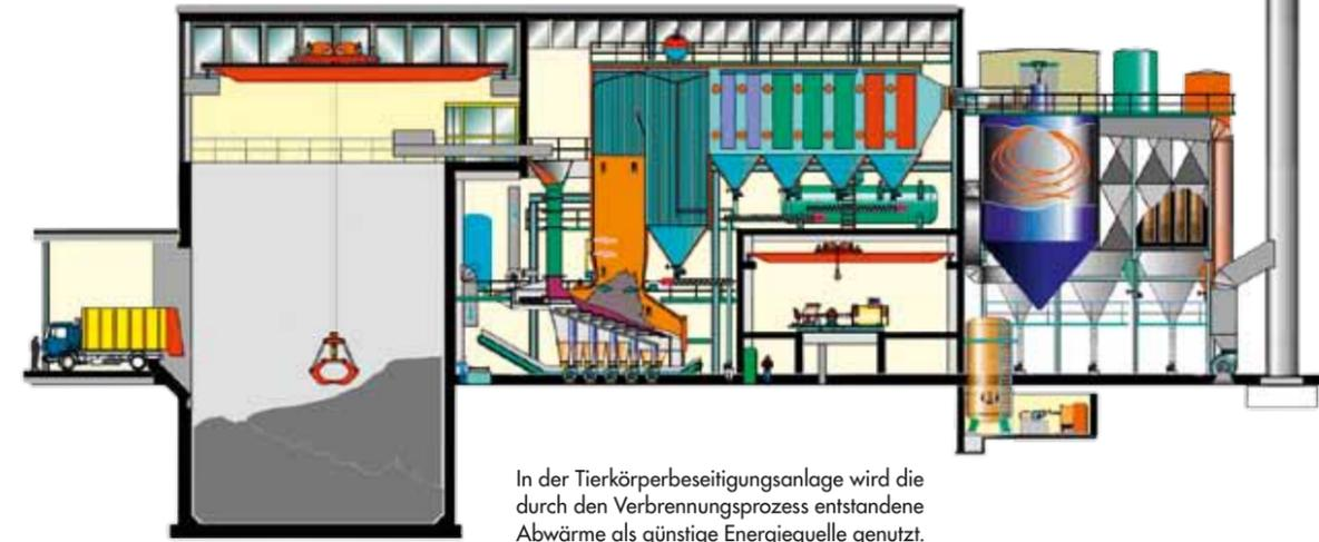
In der Tierkörperbeseitigungsanlage wird die durch den Verbrennungsprozess entstandene Abwärme als günstige Energiequelle genutzt.
