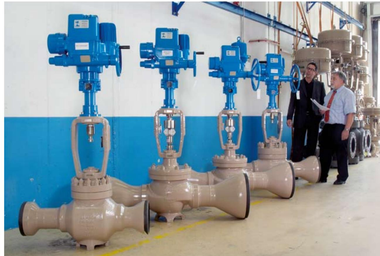
Algunas válvulas de control para la nueva central eléctrica por combustión de carbón en Wilhelmshaven está lista para pasar la inspección final del cliente.
