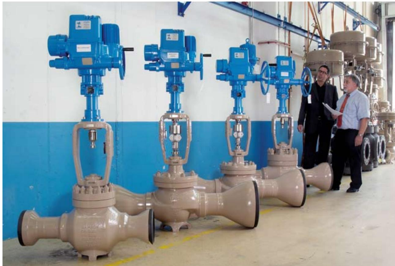
Ein Teil der Stellventile für das neue Steinkohlekraftwerk in Wilhelmshaven steht hier für die Endabnahme durch den Kunden bereit.
