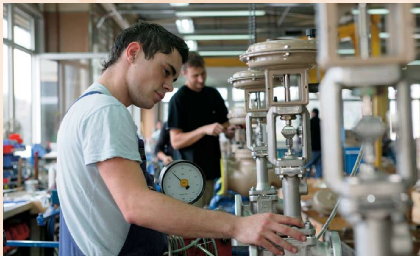
Los aprendices se capacitan en el montaje de válvulas durante el proceso de producción real.
