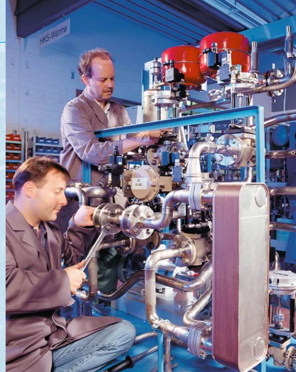
Montaje final de un sistema de calefacción y refrigeración en Lauda
