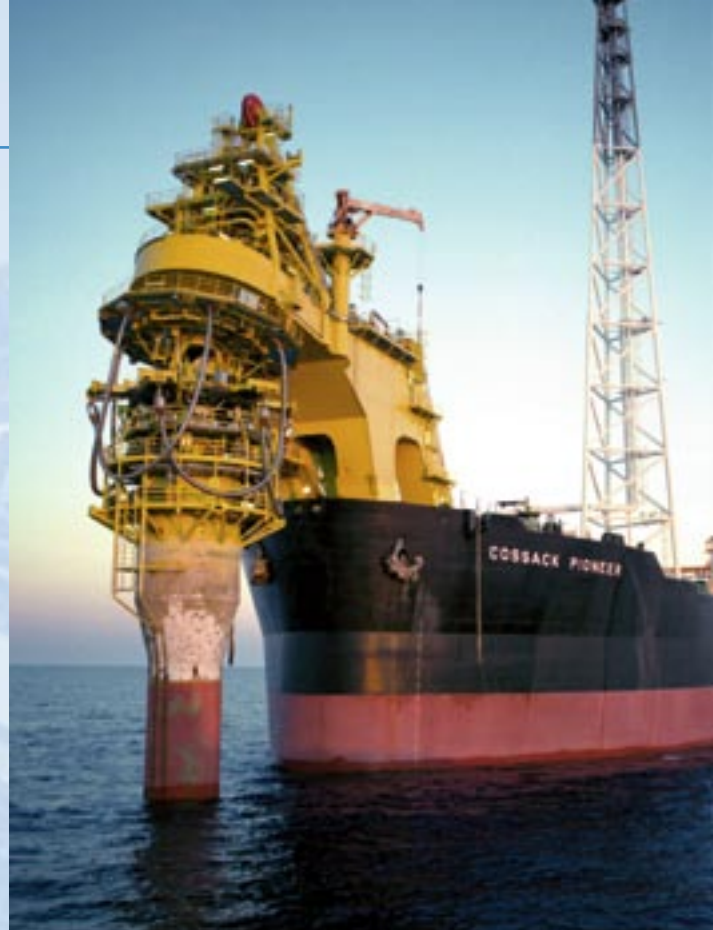
Die Cossack Pioneer ist mit ihrem Verankerungszylinder (Turret) am Bug an die unterseeischen Förderleitungen angeschlossen. Sie liegt 112 km nordwestlich von Karratha an der Küste Westaustraliens. Das FPSO-Schiff fördert pro Tag bis zu 150.000 Barrel Rohöl, die an Bord in Öl, Gas und Kondensat weiterverarbeitet werden.
