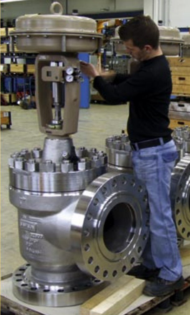
Endmontage eines Eckventils der Nennweite 300 in Edelstahl Ausführung für das chinesische Puguang Natural Gas Purification Project
