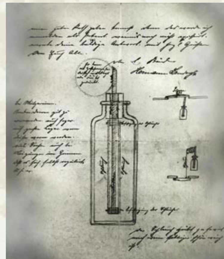
Hermann Sandvoss sfrutta il principio della dilatazione dei liquidi, in combinazione con un soffiello metallico affidabilissimo, per regolare la temperatura.
