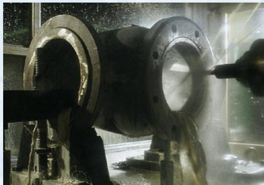
Il centro di lavorazione CNC a Francoforte con elevata precisione di posizionamento e capacità di taglio è in grado di gestire l'intero processo di lavorazione richiesto per la produzione di corpi valvola.
