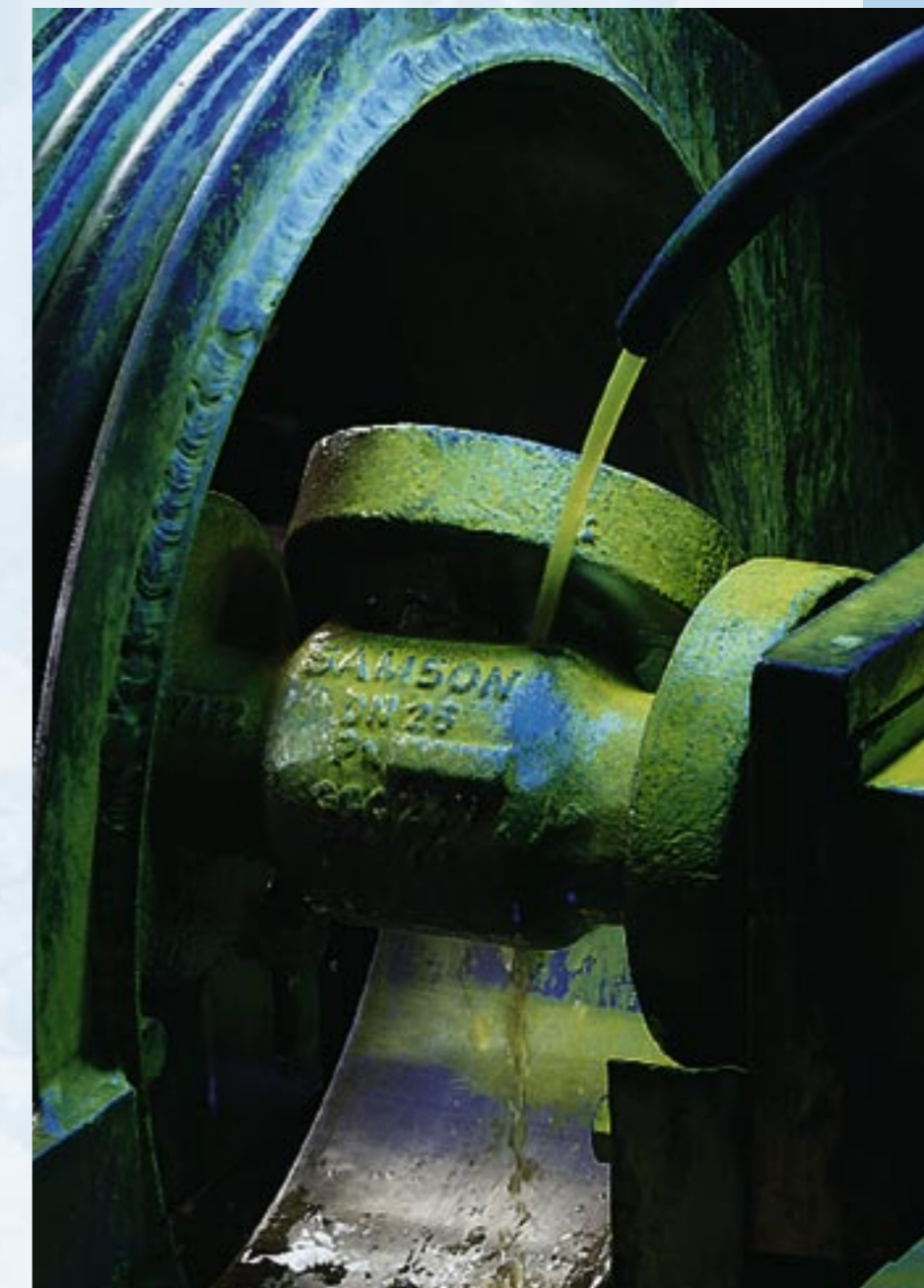
Le particelle ferrose fluorescenti presenti in ogni fessura durante l'incrinoscopia magnetica vengono evidenziate mediante luce ultravioletta.
