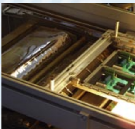
Non tutti gli elementi possono essere assemblati automaticamente su circuiti stampati. I componenti vengono saldati in un bagno ad onda sulla parte inferiore del circuito.
