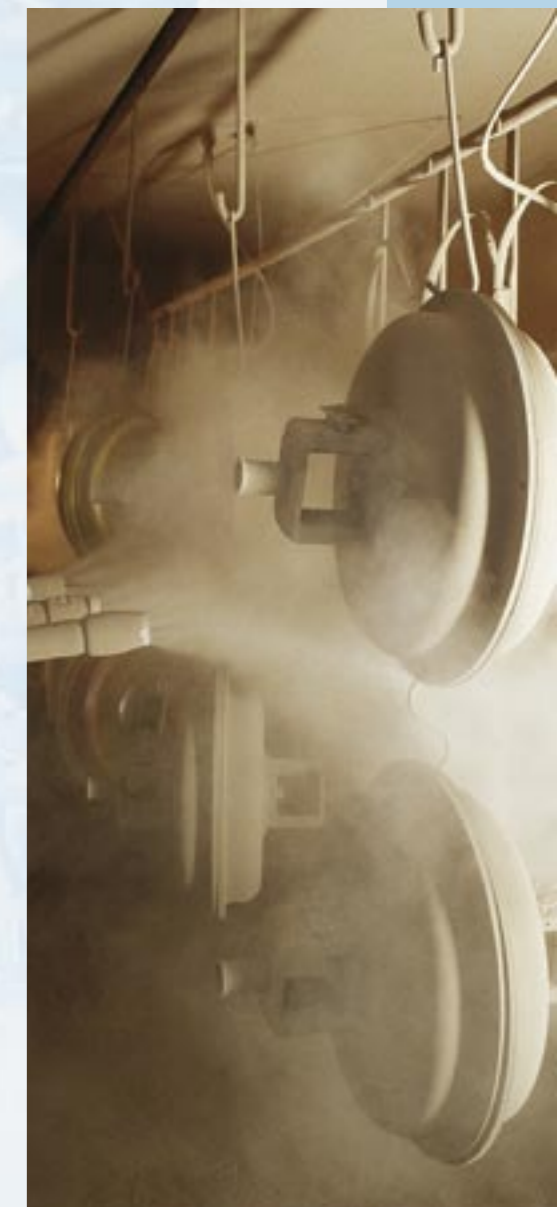
La verniciatura standard si effettua in modo automatizzato per deposito elettrostatico. Richieste particolari ed i ritocchi avvengono manualmente.
