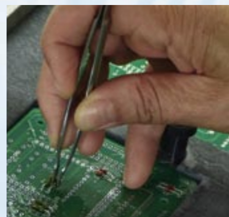
Non tutti gli elementi possono essere assemblati automaticamente su circuiti stampati. I componenti vengono saldati in un bagno ad onda sulla parte inferiore del circuito.
