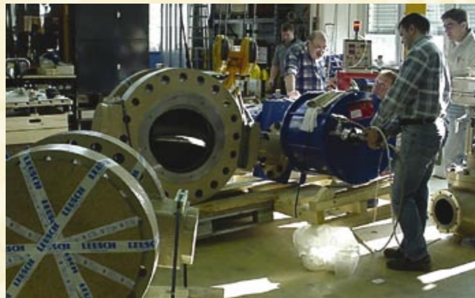
Valvole LEUSCH a farfalla triplo eccentrico destinate ad un progetto SAMSON vengono sottoposti ad accurati test funzionali prima della consegna.
