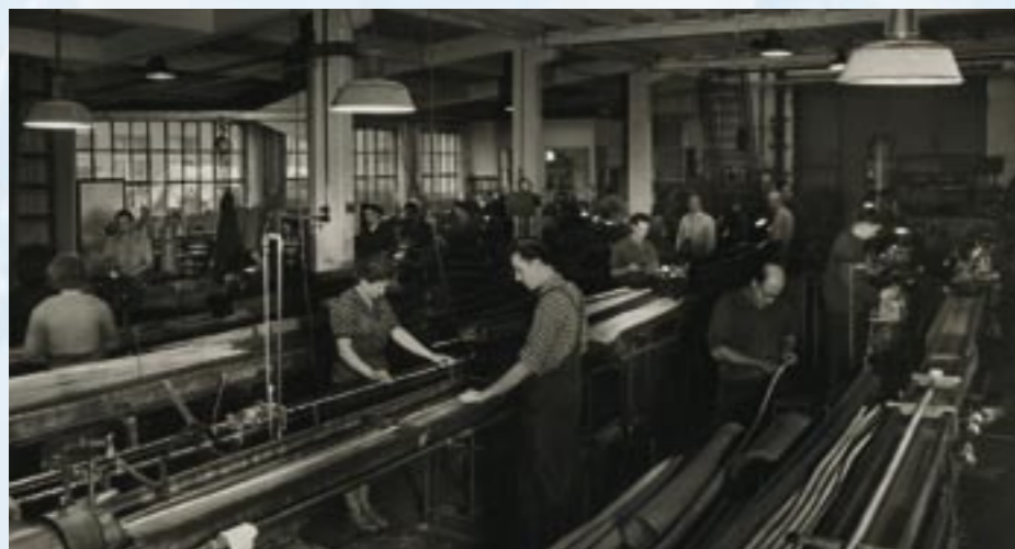
Agli inizi la produzione di tubi Bourdon e soffiotti metallici richiedeva un'intensa mano d'opera. Oggi viene sostituita da processi automatizzati.
