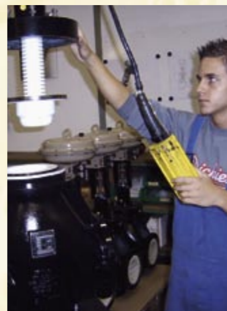
Montaggio di un coperchio valvola Pfeiffer con otturatore e soffietto in PTFE.
