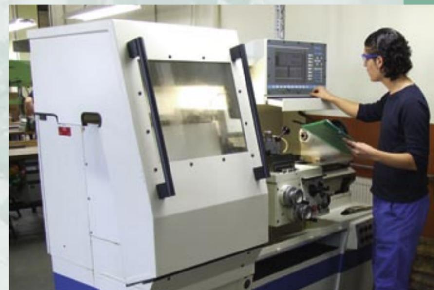
L'usinage par enlèvement de copeaux est également possible dans l'atelier de formation sur un tour à commande numérique.
