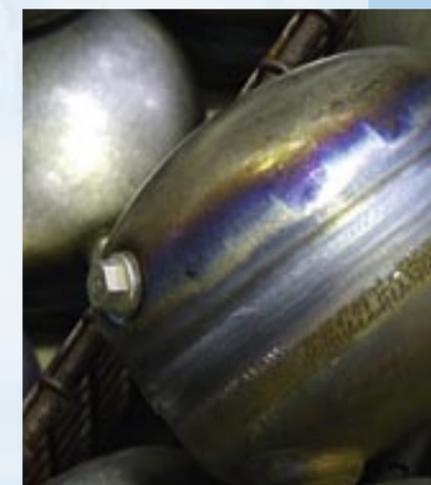
Un procédé particulier de soudage est le soudage plasma dont le matériau de soudage n'est plus appliqué en fondant un fil ou par électrode mais fourni directement par une poudre dans la flamme plasma. Ce procédé permet d'assembler des alliages spéciaux. Ce procédé nécessite également une connaissance très pointue des associations de matériaux et des traitements à chaud préalables.
