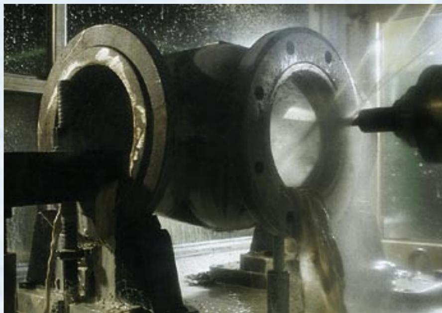
Le centre d'usinage à haute précision de positionnement et grande capacité de découpe est capable d'effectuer l'usinage complet des corps de vanne.
