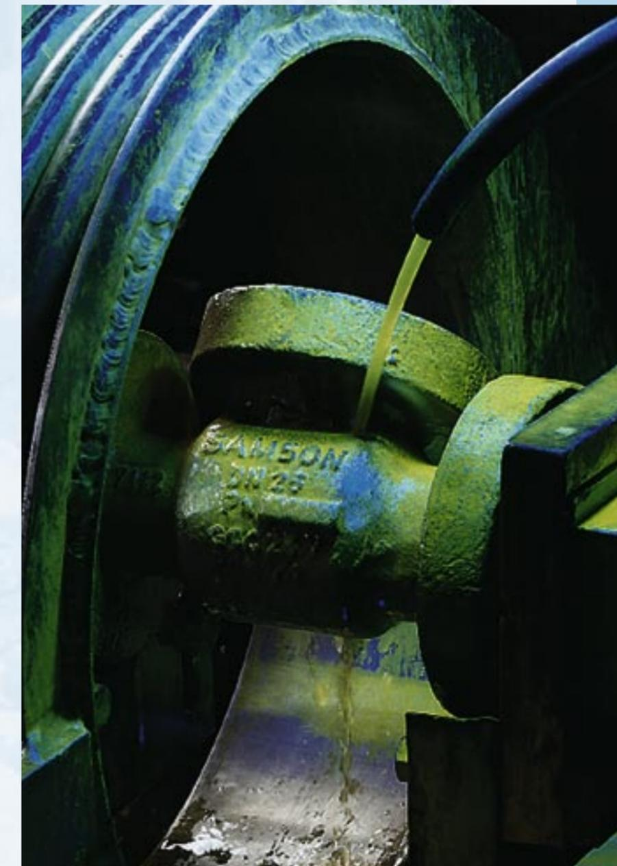
La magnétoscopie consiste à répandre une poudre de fer fluorescente sur une pièce soumise à un champ magnétique pour détecter d'éventuelles fissures par ultraviolet.
