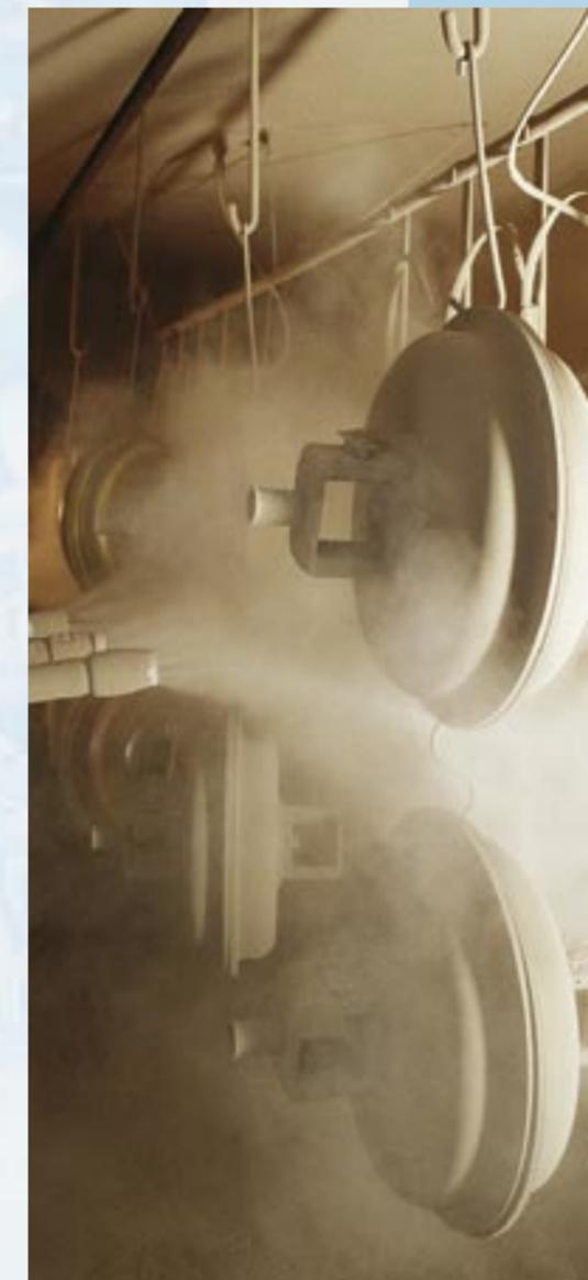
La peinture standard est appliquée en automatique par projection électrostatique. Les revêtements sur demande spéciale et réparations sont faits à la main.
