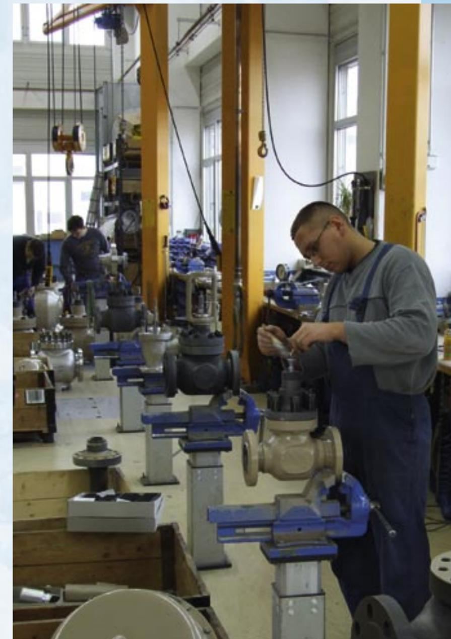
Le montage des vannes associe la fabrication automatisée à l'habileté manuelle. L'assurance qualité permanente fait partie intégrante du processus de fabrication.
