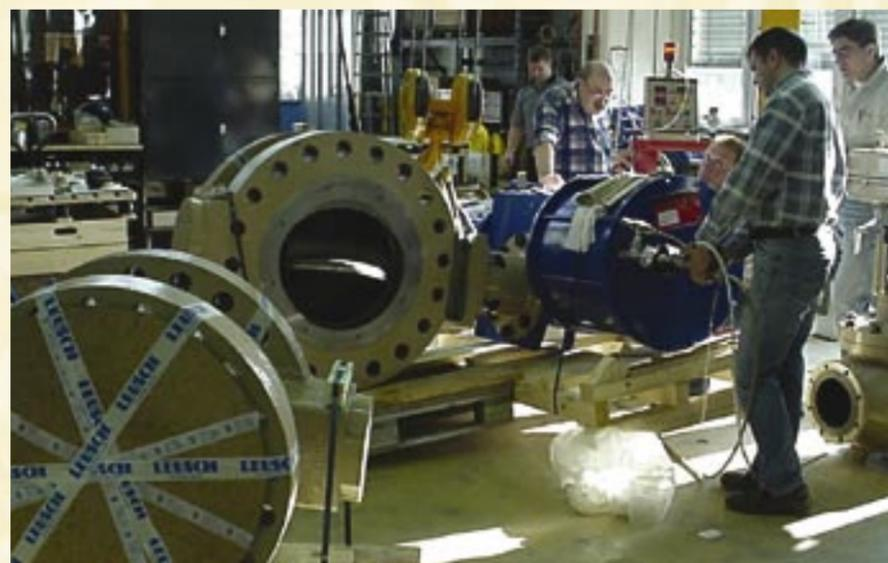
Des vannes papillon à triple excentration de LEUSCH fabriquées pour un projet SAMSON sont soumises à des tests de fonctionnement approfondis avant leur envoi.
