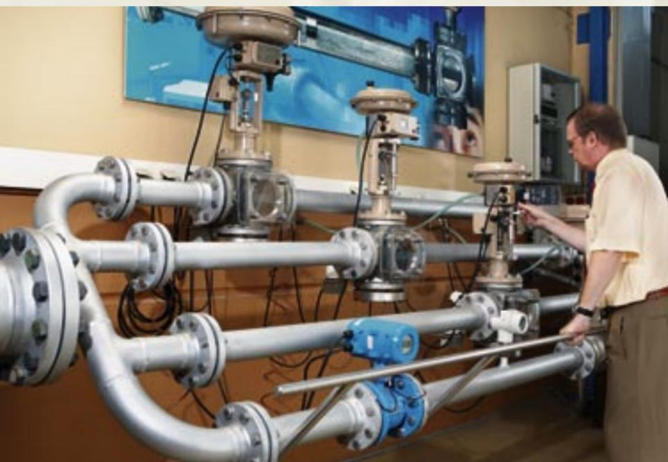
Les positionneurs avec communication bus sont testés avec des postes de commande et des sondes dans les conditions réelles d'utilisation.
