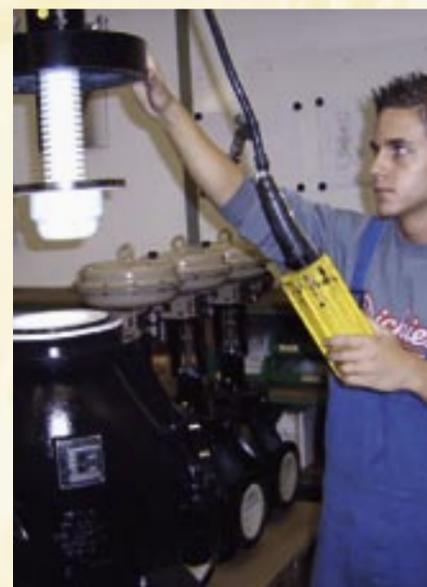
Montage d'un chapeau de vanne PFEIFFER avec clapet et soufflet d'étanchéité en PTFE.
