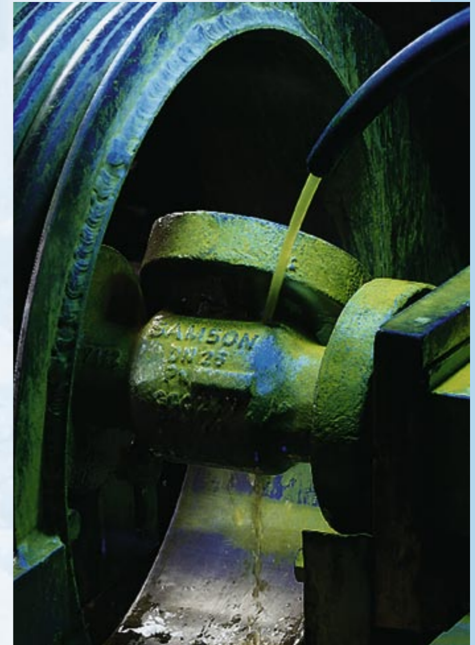
Las partículas fluorescentes de hierro presentes en cualquier fisura durante una prueba de partículas magnéticas se hacen visibles bajo la luz ultravioleta.
