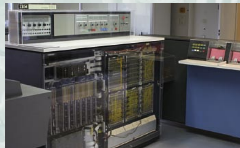
La memoria de 16 Kbyte del primer ordenador central de SAMSON, un IBM S/360-20 era suficiente para gestionar todas las transacciones contables por medio de un sistema de tarjetas perforadas.
