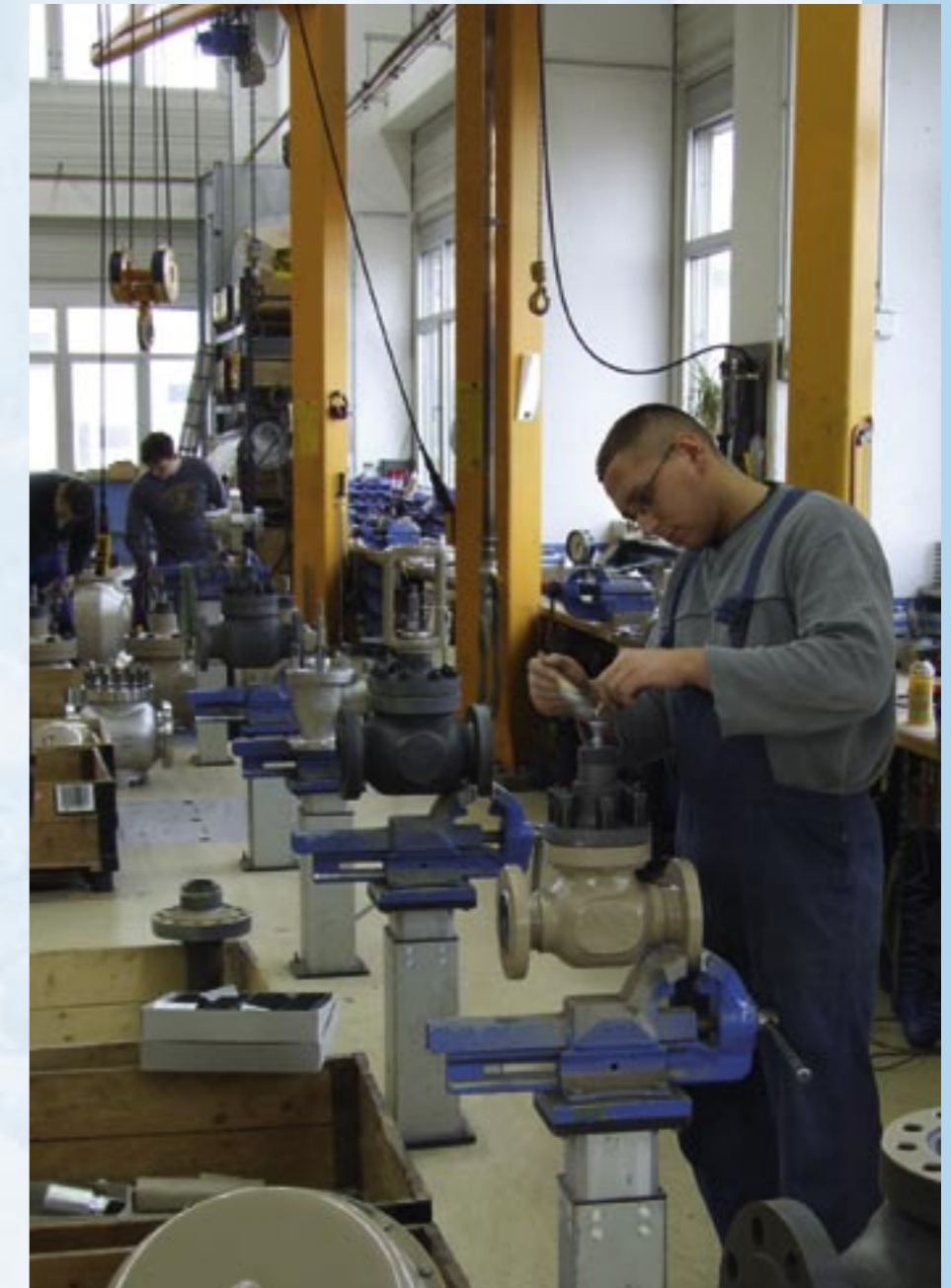
El montaje de válvulas combina producción automatizada y artesanal. El control de calidad continuo es una parte integral de los procesos de producción.
