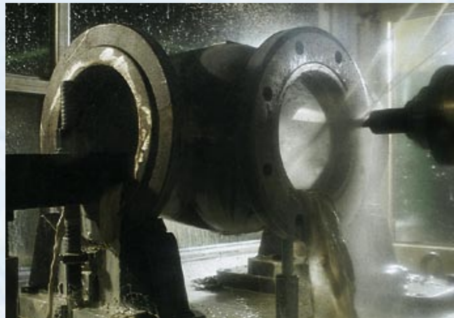
Los centros de mecanizado CNC con alta precisión de posicionamiento y capacidad de corte son capaces de mecanizar completamente los cuerpos de válvula..
