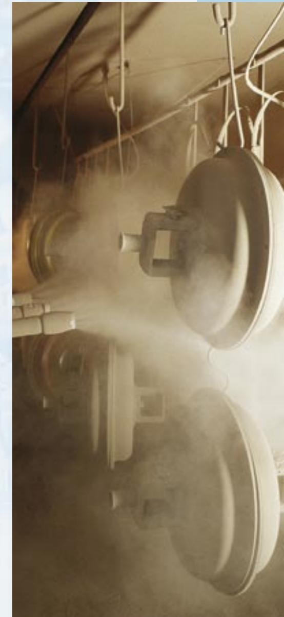
La pintura estándar se aplica por rociado electrostático. Los recubrimientos especiales se realizan manualmente.
