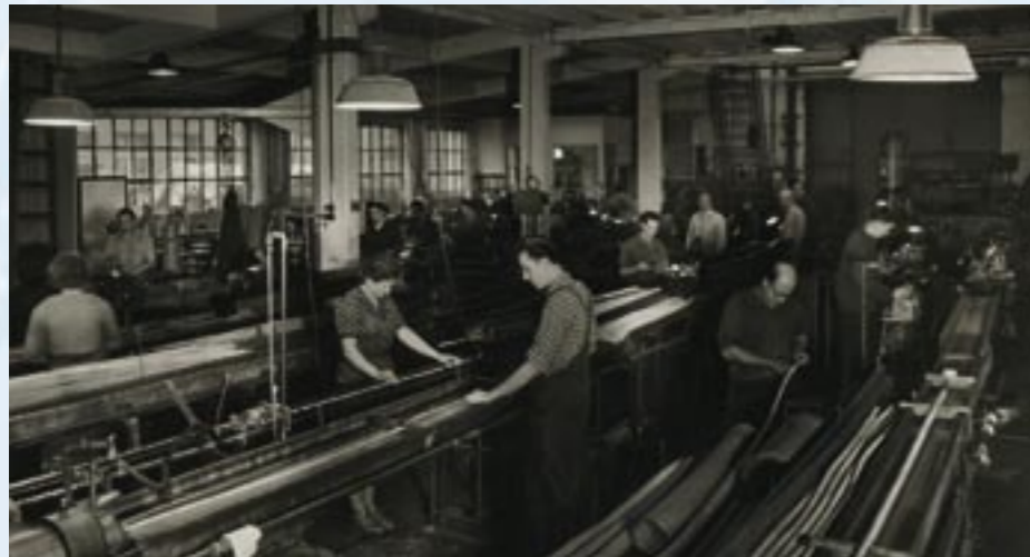
Al principio la producción de tubos Bourdon y fuelles metálicos requería una gran cantidad de mano de obra. La tecnología moderna ha evolucionado a procesos automatizados.
