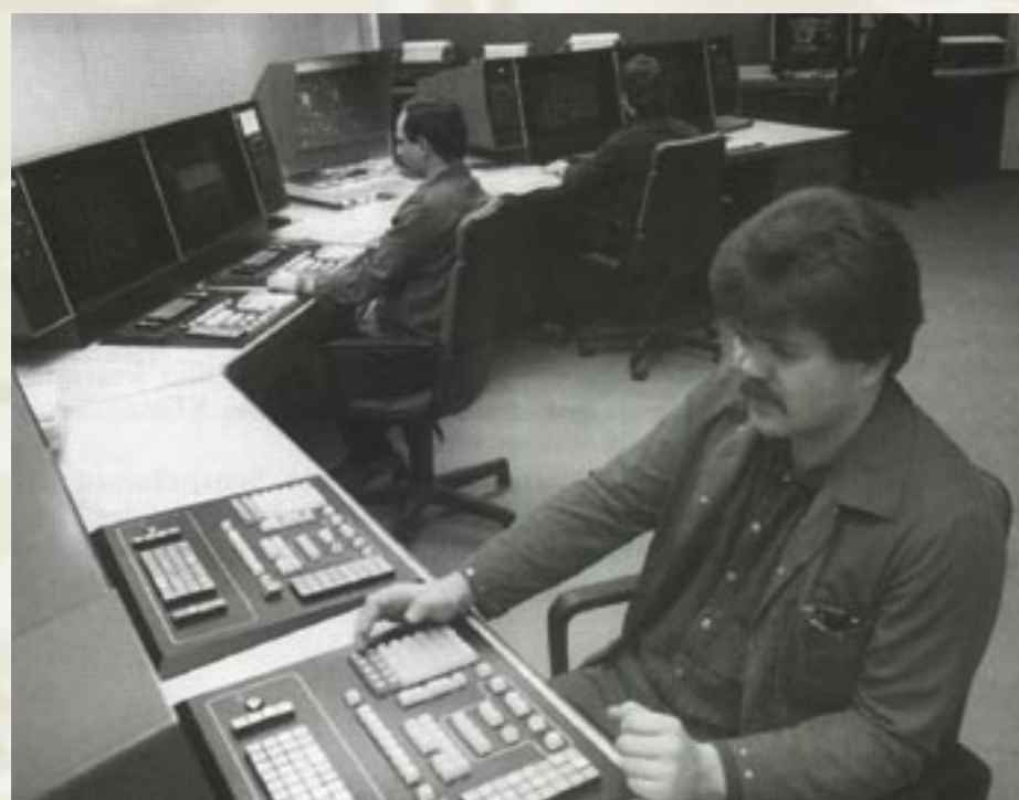
Lugar de trabajo en una sala de control con sistema de control de procesos por el año 1975. Púlpitos con pantallas y teclados reemplazaron las paredes llenas de instrumentos.
