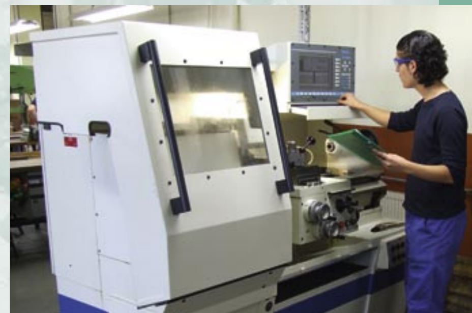
En el taller de aprendizaje también se dispone de un torno CNC (Computerized Numerical Control).
