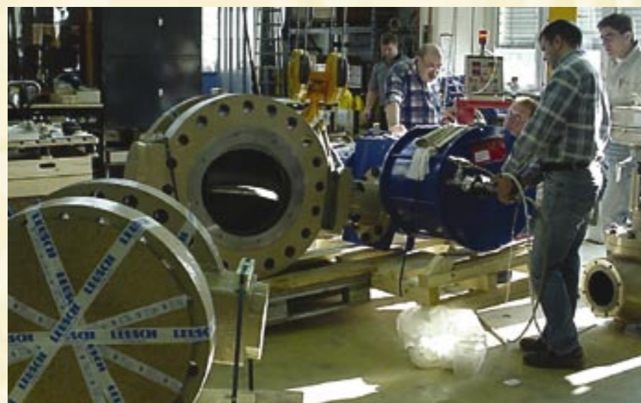
Válvulas de mariposa con triple excentricidad de LEUSCH suministradas para un proyecto de SAMSON. Antes de su envío se someten a exhaustivas pruebas finales.
