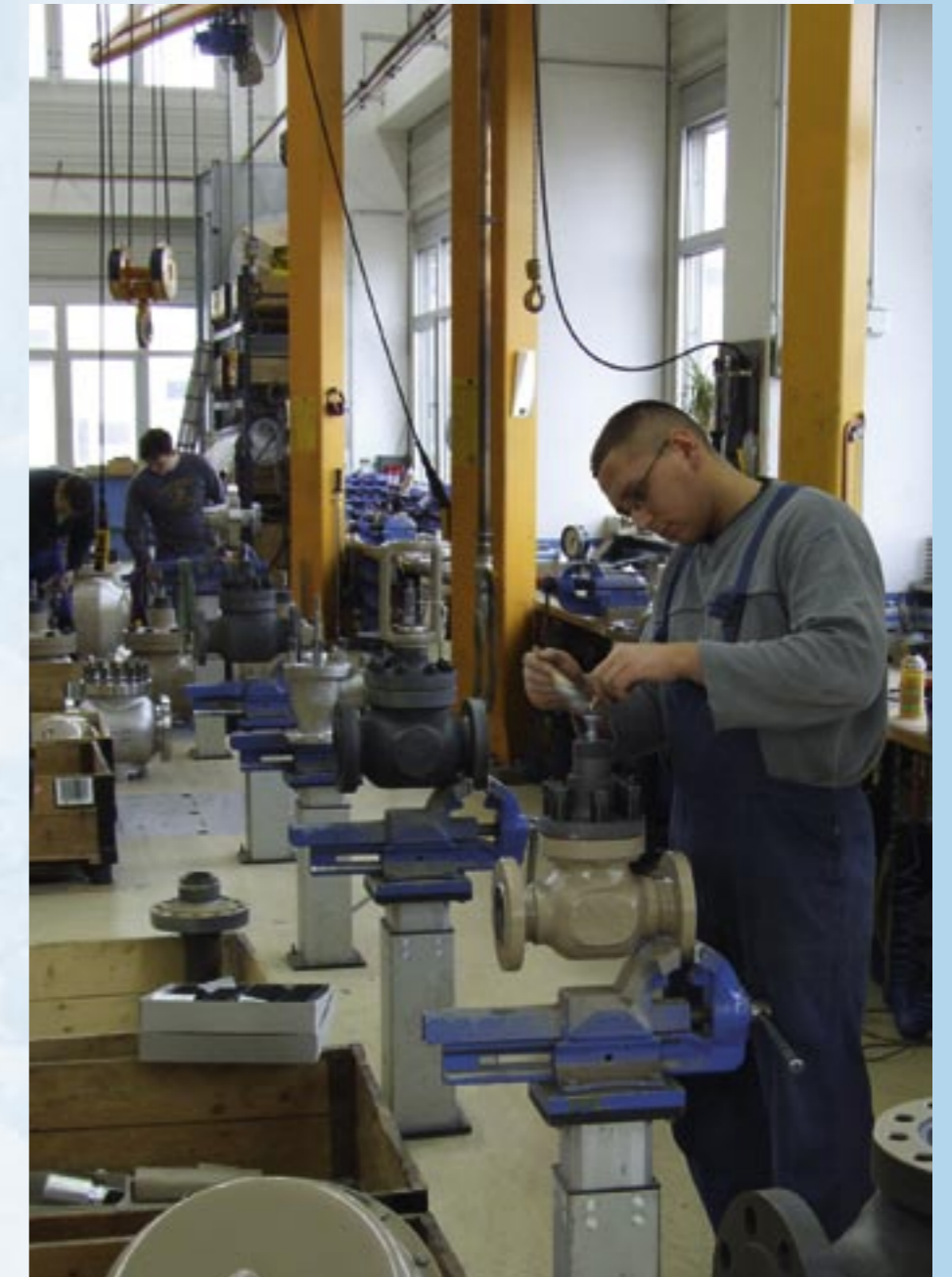
In der Ventilmontage verbinden sich automatische Fertigungstechnik und solides Handwerk. Die ständige Qualitätssicherung ist ein integraler Bestandteil der Abläufe.
