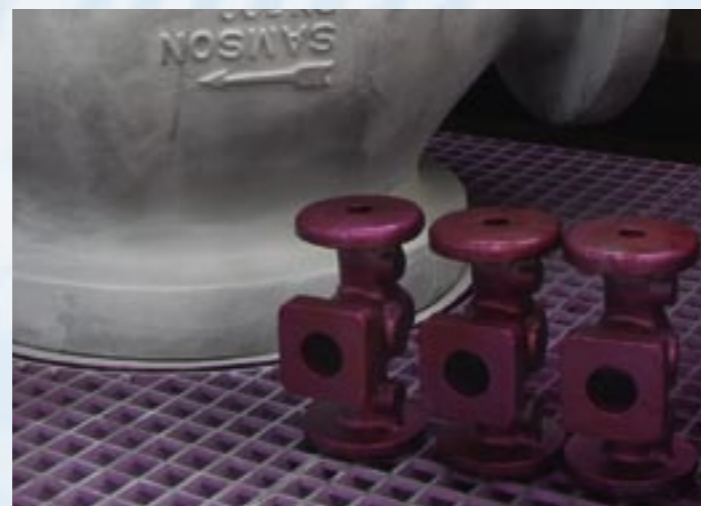
CNC-Koordinatenmessmaschinen mit luftgelagerten Führungen prüfen mit hochpräzisen Tastern die Toleranzen der Werkstückkonturen in allen drei Achsen. · Die Oberfläche von austenitischen Gussgehäusen wird mit dem Farbeindringverfahren auf Rissfreiheit untersucht.
