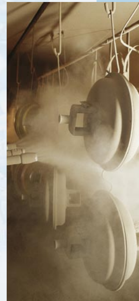
Die Standardlackierung erfolgt automatisiert durch elektrostatisches Spritzen. Spezielle Kundenwünsche und Reparaturen werden in Handarbeit erledigt.
