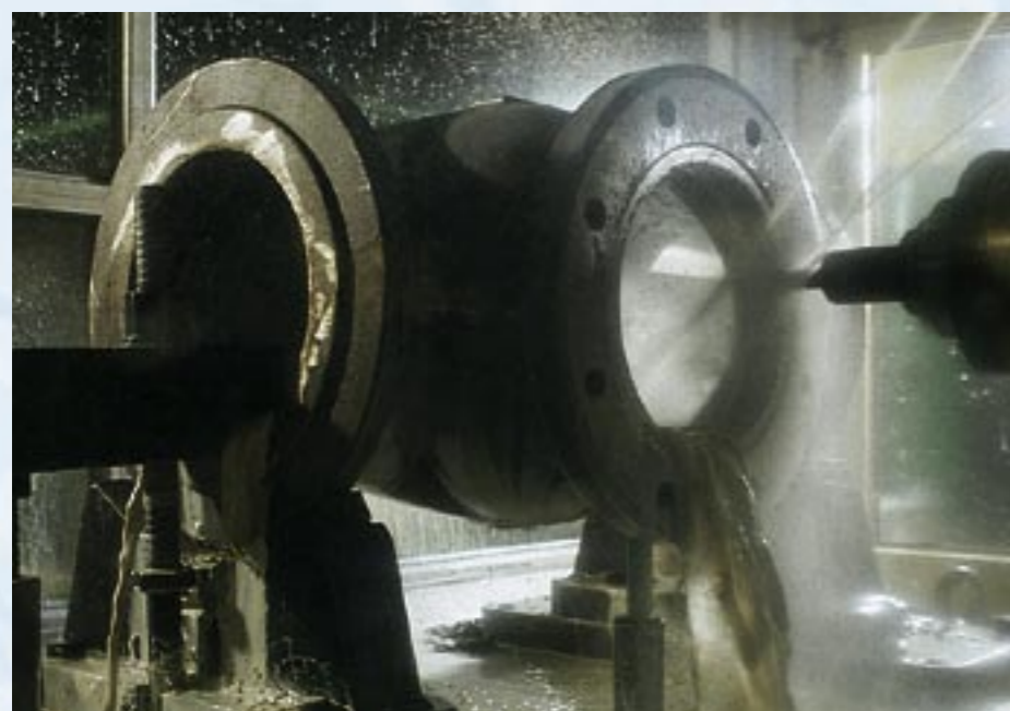
CNC-Bearbeitungszentren mit hoher Positioniergenauigkeit und Zerspanleistung ermöglichen die Komplettbearbeitung von Ventilgehäusen.
