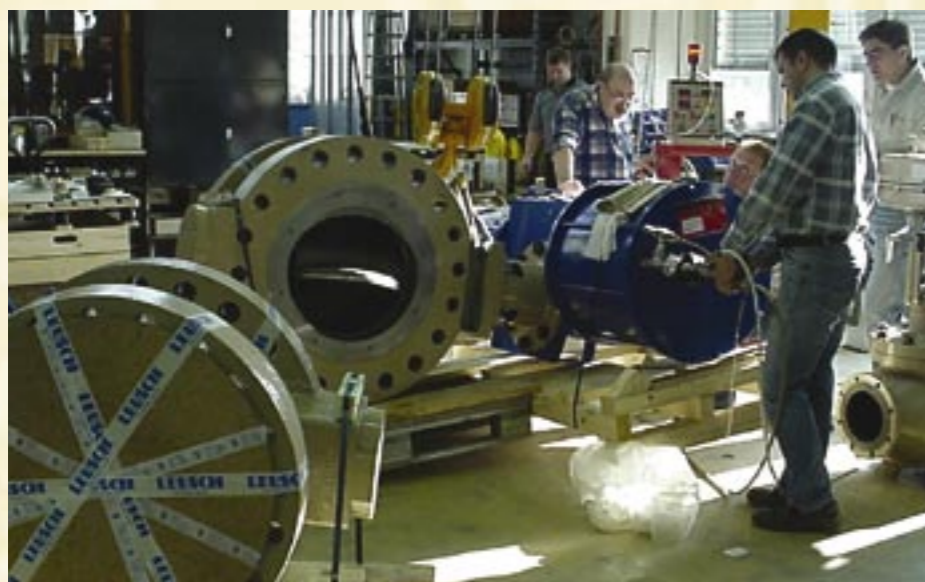
Dreifach-exzentrische LEUSCH-Klappen für ein SAMSON-Projekt werden vor dem Versand einem umfassenden Funktionstest unterzogen.
