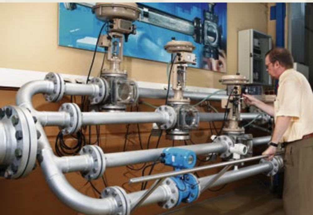
Die busfähigen Stellungsregler werden unter praxisnahen Bedingungen im Zusammenspiel mit Leitstationen und Sensoren auf dem Prüfstand getestet.
