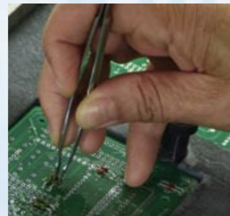
Nicht alle Bauteile können vollautomatisch bestückt werden. · Im Wellenbad werden die Bauteile auf der Unterseite der Leiterplatte verlötet.
