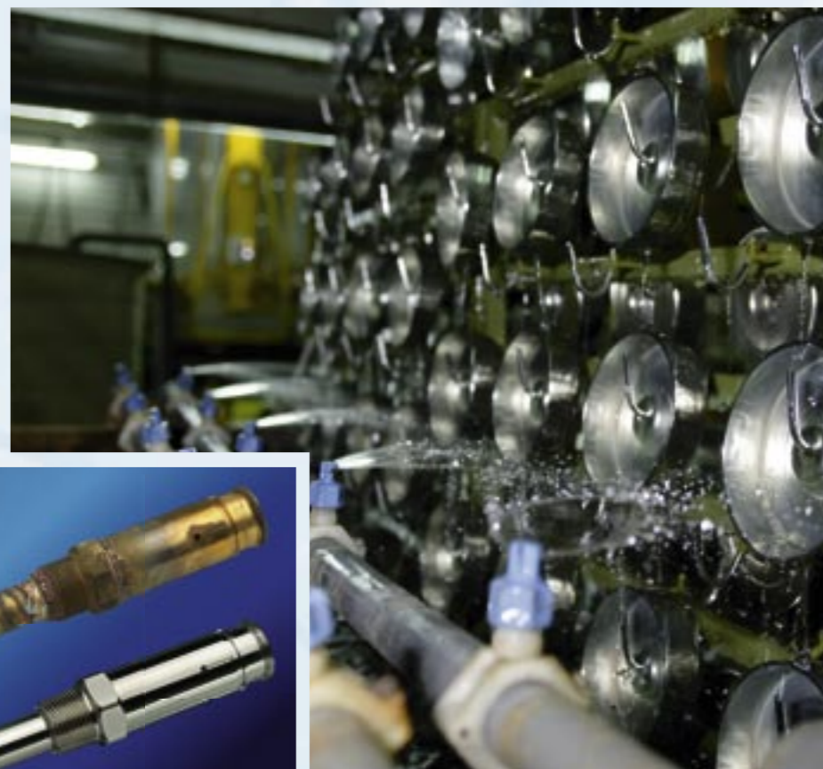
Korrosionsschutz wird bei SAMSON groß geschrieben. In der weitgehend automatisierten Galvanik werden die Oberflächen der Teile nach dem jeweils optimalen Verfahren veredelt.
