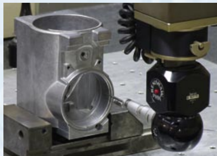
CNC-Koordinatenmessmaschinen mit luftgelagerten Führungen prüfen mit hochpräzisen Tastern die Toleranzen der Werkstückkonturen in allen drei Achsen. · Die Oberfläche von austenitischen Gussgehäusen wird mit dem Farbeindringverfahren auf Rissfreiheit untersucht.
