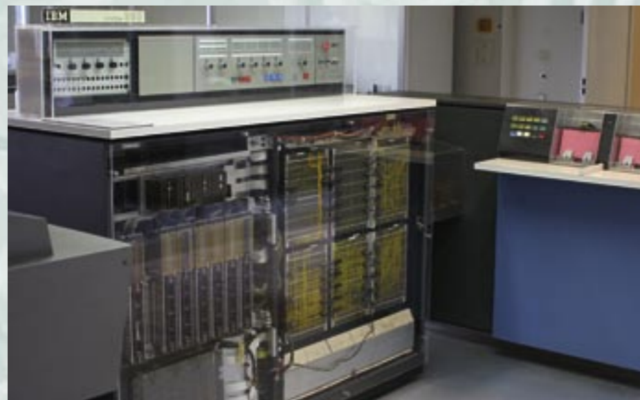
Die 16 Kilobyte des ersten 1966 installierten Großrechners IBM S/360-20 genügte, um mit Hilfe von Lochkarten und Stapelverarbeitung die gesamte Buchhaltung von SAMSON zu bewältigen.
