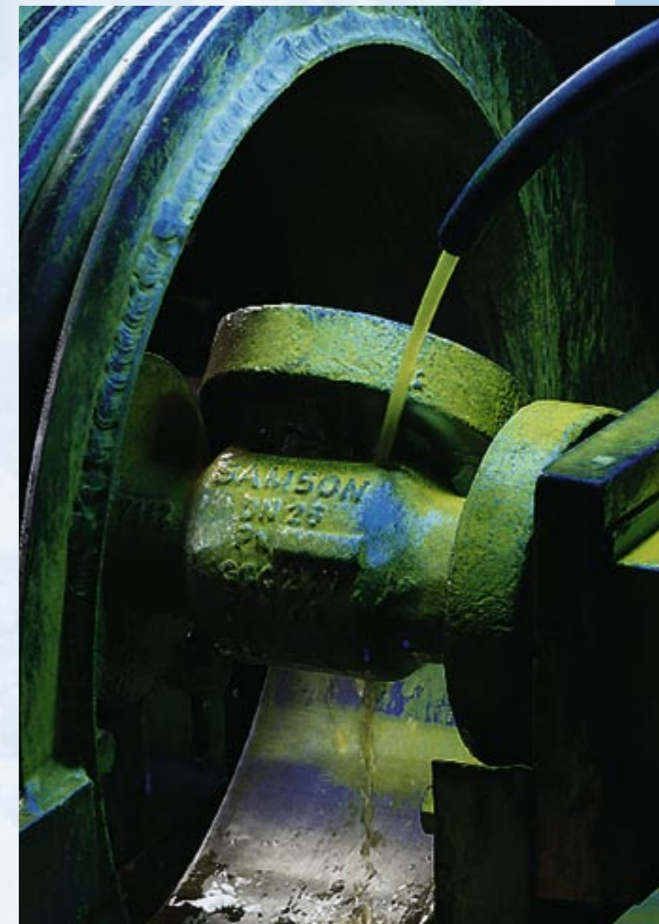
Bei der Magnetpulverprüfung setzt sich das fluoreszierend eingefärbte Eisenpulver an den Rissen des magnetisierten Werkstückes fest und wird unter UV-Licht sichtbar.
