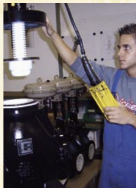
Ein Pfeiffer-Ventiloberteil mit Kegel und Balgabdichtung aus PTFE wird montiert.
