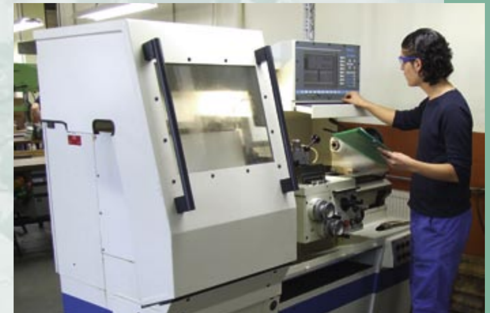
Zerspannt wird auch in der Lehrwerkstatt auf einer CNC-Drehmaschine (Computerized Numerical Control).
