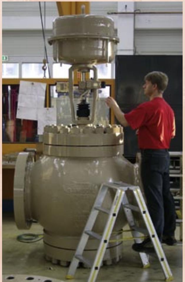
Montaje del posicionador encapsulado, uno de los últimos retoques antes de la inspección de la válvula.
