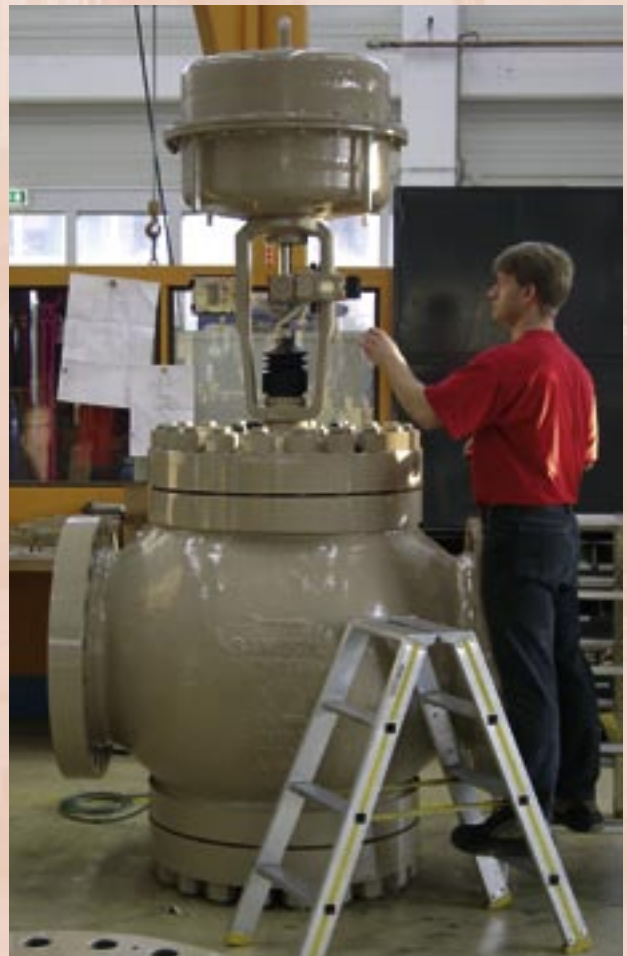
Einer der letzten Handgriffe vor der Abnahme: Die Montage des druckgekapselten Stellungsreglers.
