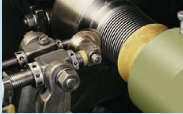
SAMSON produce soffielli standard in materiale inox con macchine sviluppate in proprio.
