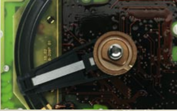
La toma de la carrera analógica trabaja sin engranajes de forma rápida y precisa.
