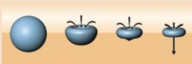
Représentation schématique montrant l'apparition du microjet.
