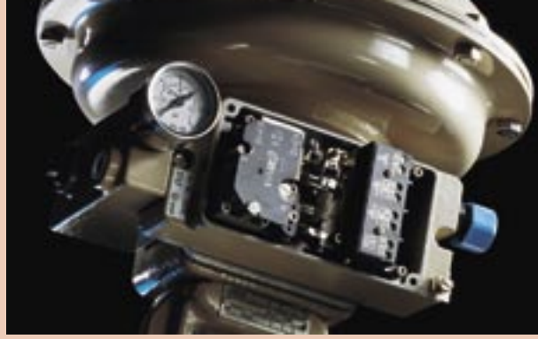
I posizionatori integrati assicurano alte prestazioni ed un corretto funzionamento della valvola Tipo 241.
