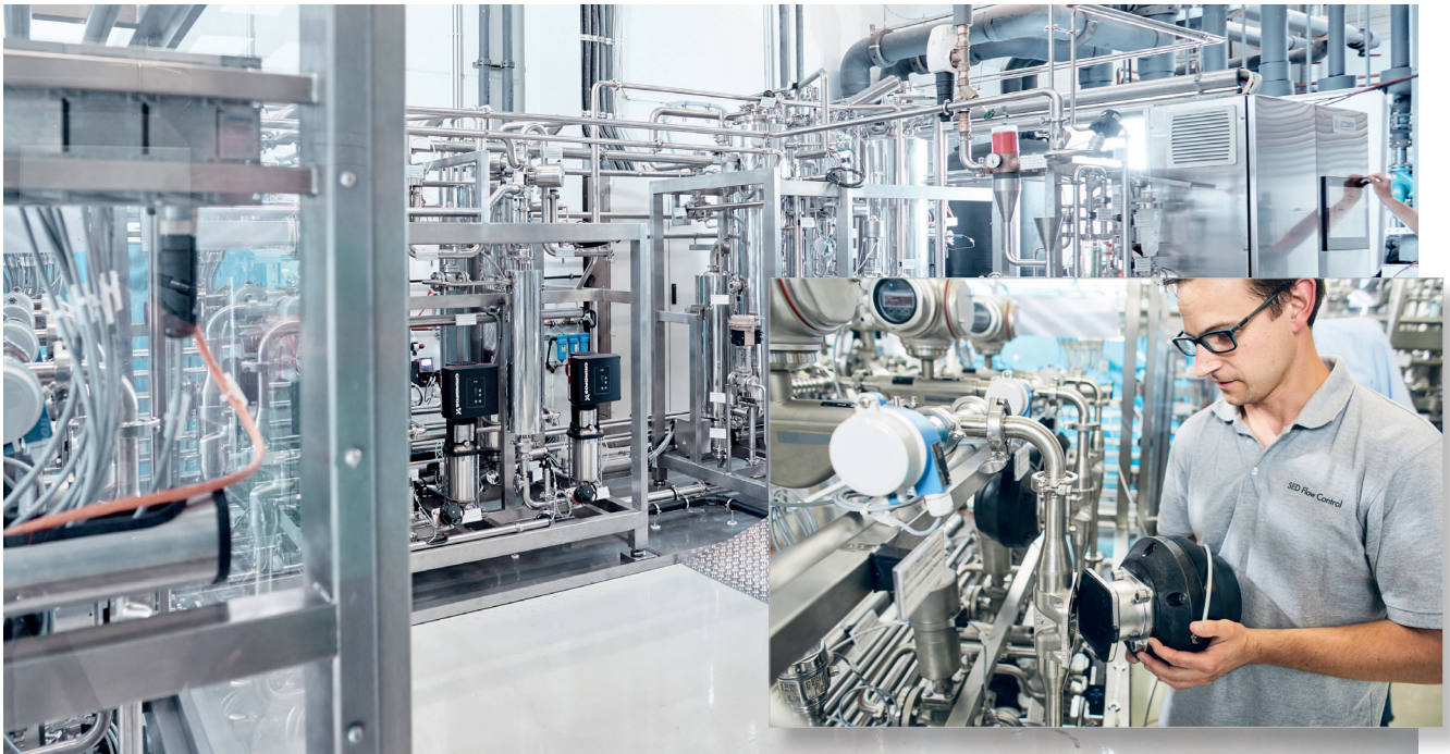
Prozessprüfstand. Zyklus- und Lebensdauerprüfung von Membranen und Ventilen mit Dampf und verschiedenen CIP-Medien.
