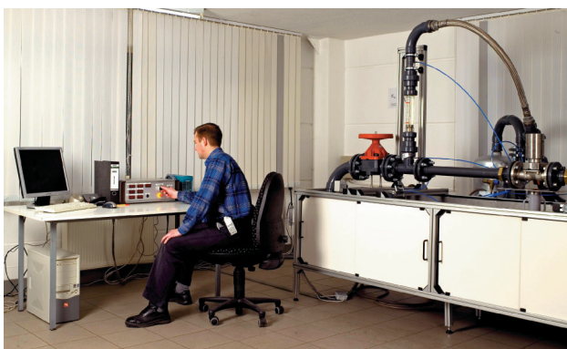
Prüfstand zur Ermittlung von Durchflusswerten
