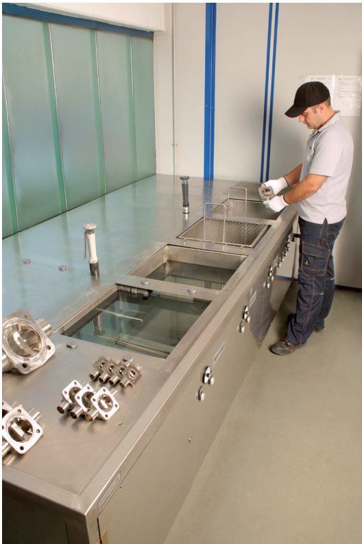
Waschanlage zum Reinigen der Ventilkörper
