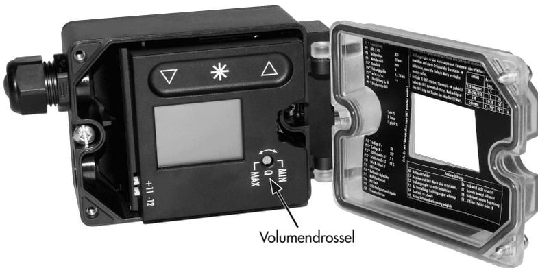
**Bild 19:** Einstellung der Volumendrossel Q (Stellung MAX/MIN)
