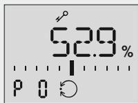
Angezeigt wird Code **PO**, Stellungsregler befindet sich im Regelbetrieb, erkennbar am Regelsymbol
