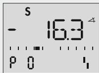
Angezeigt wird Code **PO**, das Störmeldesymbol **S** und **S** für die Sicherheitsstellung.
