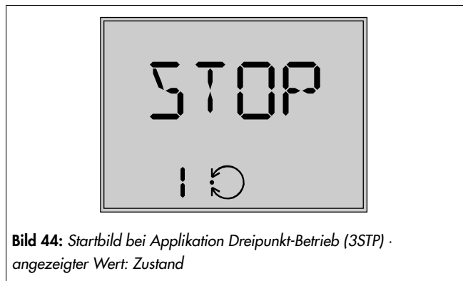
Bild 44: Startbild bei Applikation Dreipunkt-Betrieb (3STP) · angezeigter Wert: Zustand
