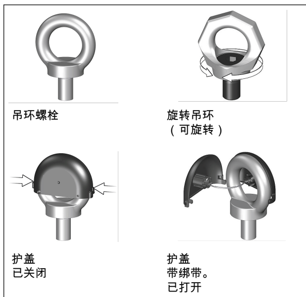
图 5: 吊环螺栓/旋转吊环上绑带
